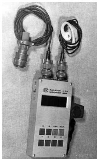
23. ábra. A Szaljut-6 űrállomás fedélzetére készült Balaton készülék
