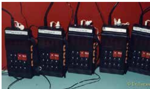
24. ábra. Medicor által sorozatban gyártott Balaton-M pszichokalkulátor
